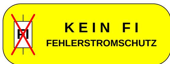
Abbildung 1: Bezeichnung Steckdose ohne FI-Schutz
