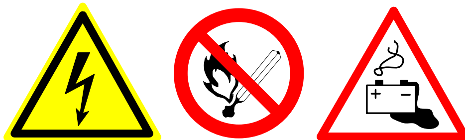
Abbildung 20: Warn- und Hinweisschilder Türen Batterieräume
